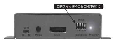
※ HDCP パススルー機能を変更する場合、DIP スイッチ設定を有効にするため、一度電源を抜き差しして下さい。
