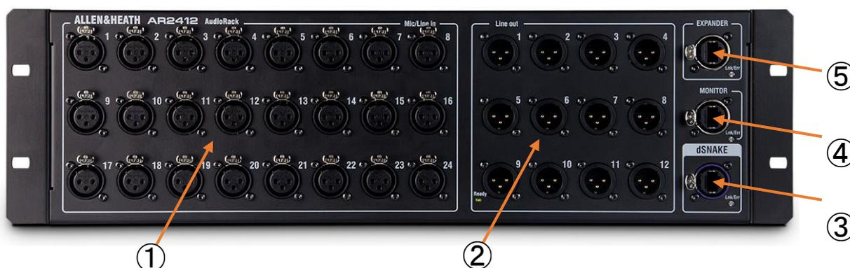
①入力端子：24系統のバランス型XLRマイク/ライン入力端子です。プリアンプはAR2412に内蔵されており、そのゲイン、パッド、48Vファンタム電源はdSNAKEリンク経由でミキサーからリモートコントロールされます。これらの端子をシステム内の入力チャンネルまたは他の宛先にパッチする方法は、ミキサーのマニュアルを参照してください。
