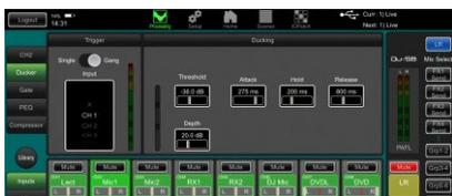
**チャンネルダッカー:**入力チャンネルまたはグループにダッカーを挿入できます。これにより、任意の信号を他のチャンネルを自動的にダッキングするために使用できます。たとえば、呼び出しマイクをトリガーに設定し、呼び出しマイク使用時にBGMチャンネルをダッキングします。
