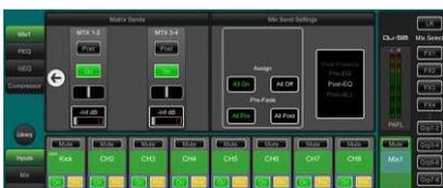
リセット時のデフォルトは、すべてプリフェード、すべてのチャンネルはアサイン済み、およびポストEQセンド(コンプレッサーの影響は受けず、EQの影響を受ける)です。これは、ミックスをモニターセンドとして使用する場合に一般的な設定です。
