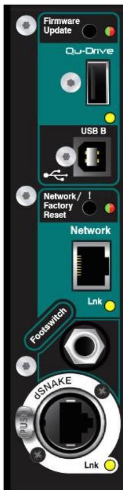
①**Networkポート**: Qu-SBは、Allen&Heath Qu-Padアプリを実行しているiPadでコントロールします。このポートにワイヤレスルーター(ワイヤレスアクセスポイント)を接続して、iPadがミキサーに接続するためのWi-Fiネットワークを設定します。ネットワーク設定は、本書後半で解説します。
