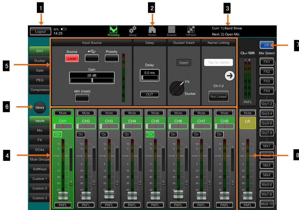
①**Logoutボタン**: アプリを切断して閉じるには、iPadのHomeボタンをダブルクリックし、画面からアプリをスワイプして終了します。アプリを開いたまま、ミキサーとの接続を切断する場合は、Logoutボタンをタッチします。
