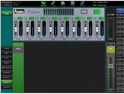
**AMM(Automatic Mic Mixing):** AMMは、会議やパネルディスカッションなど、複数のマイクで構成する喋り/スピーチのアプリケーションに非常に便利な機能です。複数の参加者ごとに設置したマイクに対して、「話されていないマイクのレベルを下げる制御」を自動で行います。これにより認知度が改善し、フィードバックのリスクを動的な制御をして減らします。
