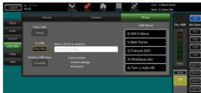
**ショーメモリー:**ショーには、現在のミックス設定、100個のシーン、ライブラリー、およびセットアップを含むすべてが格納されます。ショーはミキサー内には保存されず、Qu-Driveに接続したUSBドライブに直接作成されます。
