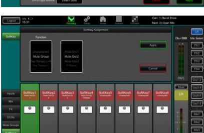
**ソフトキーを割り当てる:**ソフトキーは、ミュート、タップテンポ、シーン、Qu-Driveトランスポートなど、さまざまな機能をユーザーがアサインできます。**Processing**ページのSoftKeysストリップで機能をアサインします。**Apply**ボタンを押して適用します。
