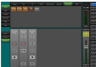
**USBデバイスのフォーマット:** **Setup/Utility/Qu-Drive**画面を使用して、レコーディング前にQuミキサーでUSBデバイスをフォーマットします。これにより、ドライブがクリアされ、Quディレクトリー構造が設定されます。
