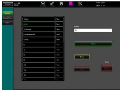
**シーンメモリー:**ミキサーのセットアップが完了したら、Scene画面に移動し、現在のミックス設定をシーンとして名前付けし、保存します。シーンはミキサー内に最大100個保存できます。
