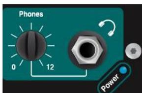
⑭**Phones Output**: Qu-PadアプリのPAFLボタンで、ミキサー内の任意のチャンネルまたはミックス信号を検聴できます。質の高いローインピーダンスのステレオヘッドホンを使用してください。Phonesつまみでレベルを調整します。
