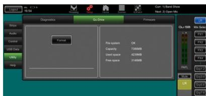
**USB経由でのデータのアーカイブと転送:**USBキーやドライブなどのUSBデバイスを使用して、Qu設定をアーカイブしたり、Quミキサー間で転送したりできます。メモリーは、すべてのQuモデルと互換性があります。**Setup/Utility/Qu-Drive**画面フォーマット機能を使用し、QuミキサーでUSBデバイスのフォーマットを開始します。
