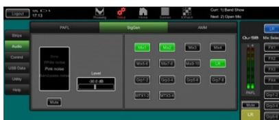
**シグナルジェネレーター:** Quミキサーはシグナルジェネレーターを内蔵しています。ピンクノイズは、スピーカーのテストに最適なソースです。すべての周波数でオクターブあたり等しいエネルギーを生成し、すべてのスピーカードライバーが動作していることを確認したり、フェイジングや極性の問題の確認に使用できます。
