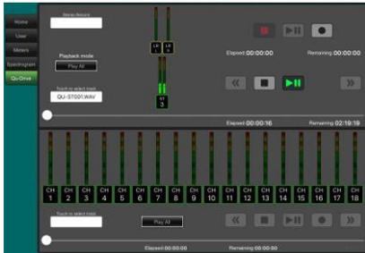
**USBデバイスへのQu-Driveレコーディング:**前面パネルのQu-Driveポートに接続したUSBストレージデバイスにステレオまたは18トラックのマルチトラックを直接レコーディングできます。
