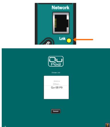
**Wi-Fiルーターを接続する:**ルーターの適切な場所に設置し、電源を入れます。LANケーブルを使用して、LANポートの1つをミキサーのネットワークポートに接続します。リンクが確立されると、黄色のネットワークLnkインジケーターが点滅します。
