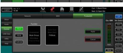
**フットスイッチ:**シングルまたはデュアルフットスイッチにコントロールをアサインできます。**Setup/Control/Footswitch**画面で機能を選択し、スイッチの動作モードをキャリブレーションします。
