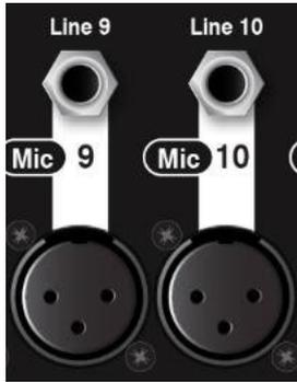
⑧**Mic Input**: マイクやDIボックスなどの出力レベルの低いソースを入力します。バランス型のXLR端子で、プリアンプは-5dBから+60dBまでの広いゲイン範囲を持っています。ファンタム電源が必要なコンデンサーマイクやアクティブなDIボックスの場合は、ファンタム電源の供給も可能です。
