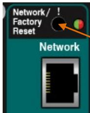
ネットワーク端子上部の埋め込み式スイッチを使用して、2つのリセット機能を使用できます。
