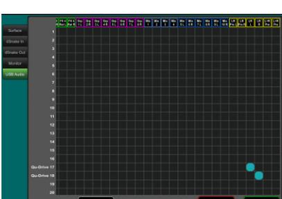
**USB出力をパッチする:****I/O Patch**ページのUSB Audio画面を使用して、Qu出力のいずれかを**Qu-Drive**マルチトラックおよび背面パネルの**USB B**ストリーミングポートにパッチします。これらは同じパッチを共有します。USB Bストリーミングは、32出力すべてを使用します。Qu-Driveレコーディングは最初の18出力から供給され、Qu-Driveステレオレコーディングは出力17-18から供給されます。
