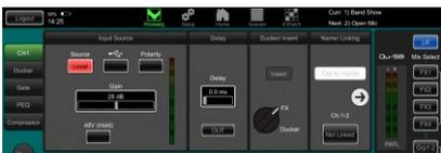
**チャンネルソースを選択する:** モノラルチャンネルとステレオチャンネルごとにローカルソケットの3つのソース(背面パネル、dSNAKEソケット(リモートIO)、またはUSB(プレイバック))から1つを選択します。リセットのデフォルトは、ローカル入力ソースです。
