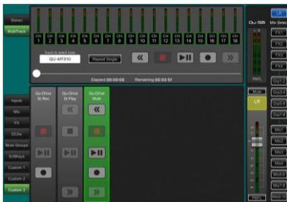
**ステレオ/マルチトラック再生(プレイバック):** **Processing**画面のPreamp sourceポップアップを使用して、USBをチャンネルのソースとしてパッチします。Global USB SourceでQu-Driveを選択します。
