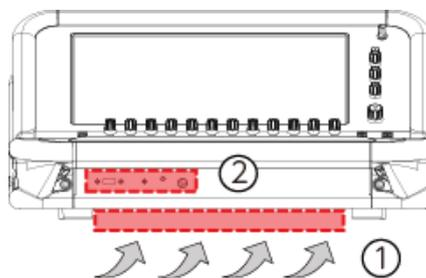
①通気口(➤)および②ミキサー後部のオーディオ/電源接続に十分な空間を残してください。
