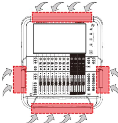
表示されている領域のミキサーの側面には、通気口(➤)のための十分な空間を残してください。
