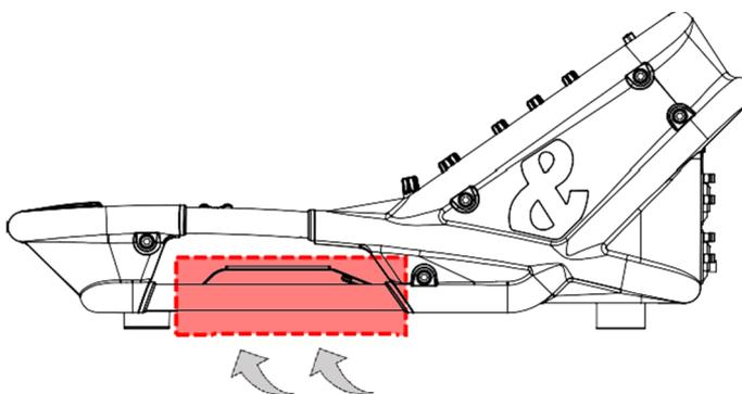
①通気口(➤)、および②ミキサー前面のUSB/ヘッドホン接続に十分な空間を残してください。
