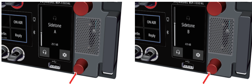
図 40 : ヘッドセット A および B 個別のサイドトーン音量を切り替える (RSP-1232HL)
