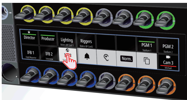
図 56：キー・ディスプレイの機能（Secondary Function ドロワー）
