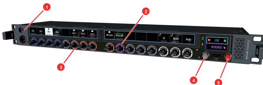
図 9 : RSP-1216HL 前面のステータス LED の位置
