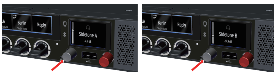
図 17 : ヘッドセット A および B のサイドトーン音量を個別に切り替える : RSP-1216HL
