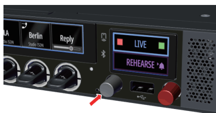
図 18 : RSP-1216HL のマイクロフォンのミュート操作
