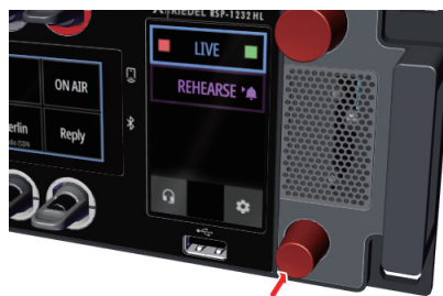
図 41 : マイクフォンのミュート操作のミュート (RSP-1232HL)
