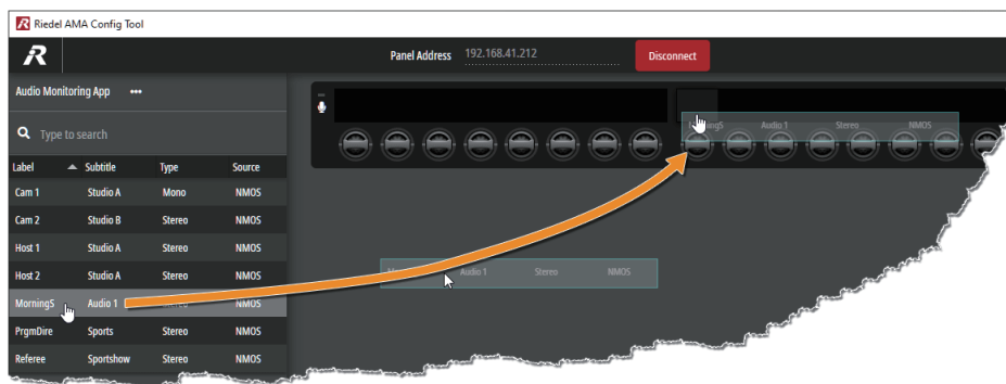
図 92 AMA Config Tool – 音声ソースの割り当て
