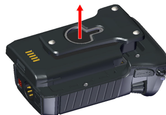
図 250：バッテリーを持ち上げる
