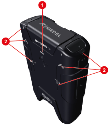
図 259 : S ベルトパック - ステータス LED (上面)
