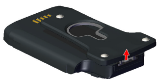
図 251：ロック・クリップを引く
