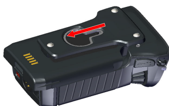
図 249：バッテリーを押す
