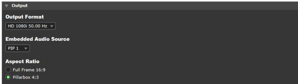
図 202: ビデオ・チャンネルのコンフィギュレーション - Output (MN-HDP6 Conversion/Quadsplit Output and Multiviewer Channels)
