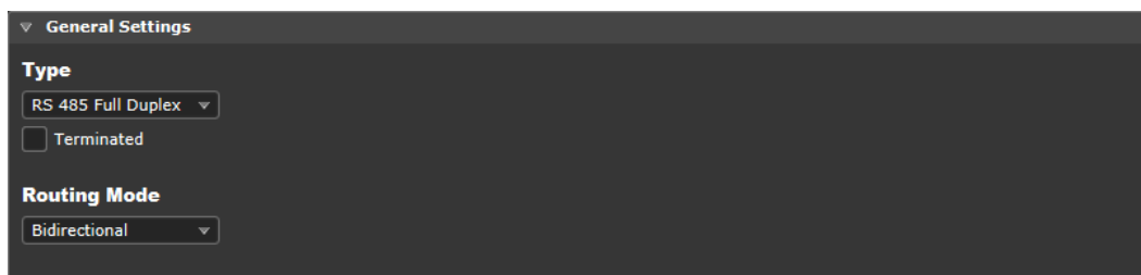
図 216：データ・チャンネルのコンフィギュレーション - General Settings (Serial)
