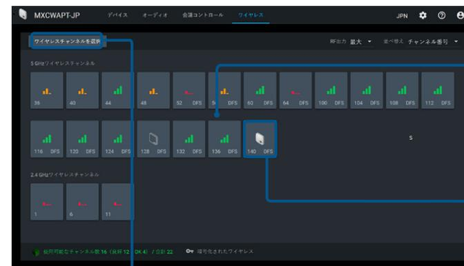
2.4GHz/5GHzのすべてのワイヤレスチャンネルを継続的にスキャンして監視し、リアルタイムで3段階評価、自動的に最も良いチャンネルに切り替えて運用。
