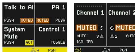
システム・ミュートは CALL および TALK 機能をすべて無効にし、全プログラム入力信号をミュートし、ボタンが押されている間、アクティブになります (PUSH 動作)。システム・ミュートが有効な場合、オレンジ色の MUTED インジケーターが表示されます。
