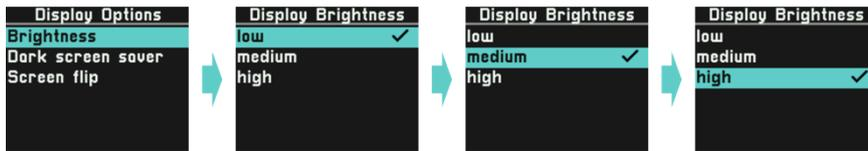
ディスプレイのバックライトの明るさを調節します。
