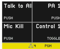
デバイスの Mic Kill ボタンをクリックすると、そのデバイスのロールが割り当てられているチャンネルのアクティブな TALK 機能がすべてリセットされます。Mic Kill ボタンを長押しすると、システム・コンフィギュレーション内で利用可能な全チャンネルのアクティブな TALK 機能がリセットされます。この機能の目的は、過度にビジーな状態にあるチャンネルを「沈黙」させ、重要 / 緊急なメッセージを送信できるようにすることです。
