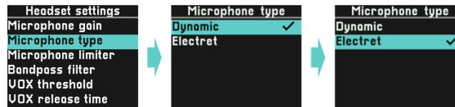
エレクトレット・マイクは正しく動作するにはバイアス電圧を必要とします。マイクの種類をエレクトレットに設定すると、マイク入力にバイアス電圧が印加されます。ダイナミック・マイクはバイアス電圧なしで動作します。
