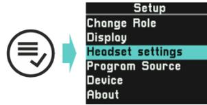
ヘッドセット設定では、I/O セットアップで事前に定義された設定にアクセスできます。これにより、特定の状況に応じて設定を微調整する選択肢が提供されます。設定はデバイスに保存され、デバイスの電源を入れたときに再び適用されます。
