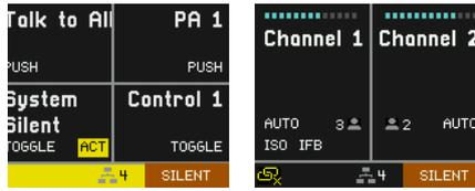
システム・サイレントは Q210P スピーカー・ステーションのスピーカーやその他の機器 (今後リリース) の音を止めます。パブリック・アナウンスメント (館内放送) はそのまま、CALL 機能使用時の視覚的な信号 (合図) もそのまま機能します。この機能はボタンの一押しで起動します。もう一度ボタンを押すと機能が解除されます (TOGGLE 動作)。システム・サイレントが有効な場合、オレンジ色の SILENT インジケーターで通知されます。
